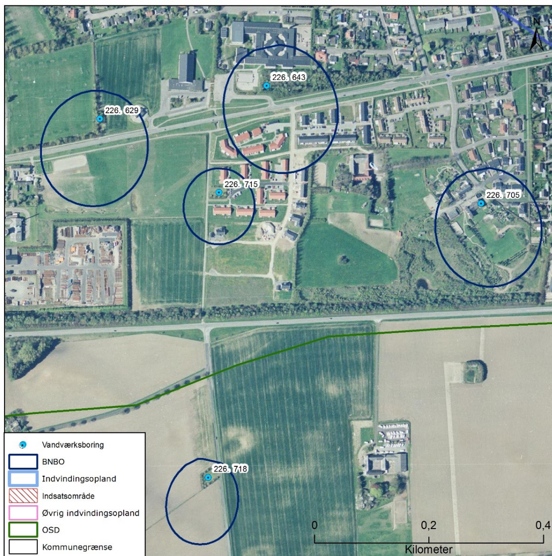
Figur Fejl! Ingen tekst med den anførte typografi i dokumentet..4 Borningsnære beskyttelsesområder (BNBO) for Præstø Vandværks indvindingsboringer, samt arealanvendelsen og udpeging af indsatsområder (IO).
