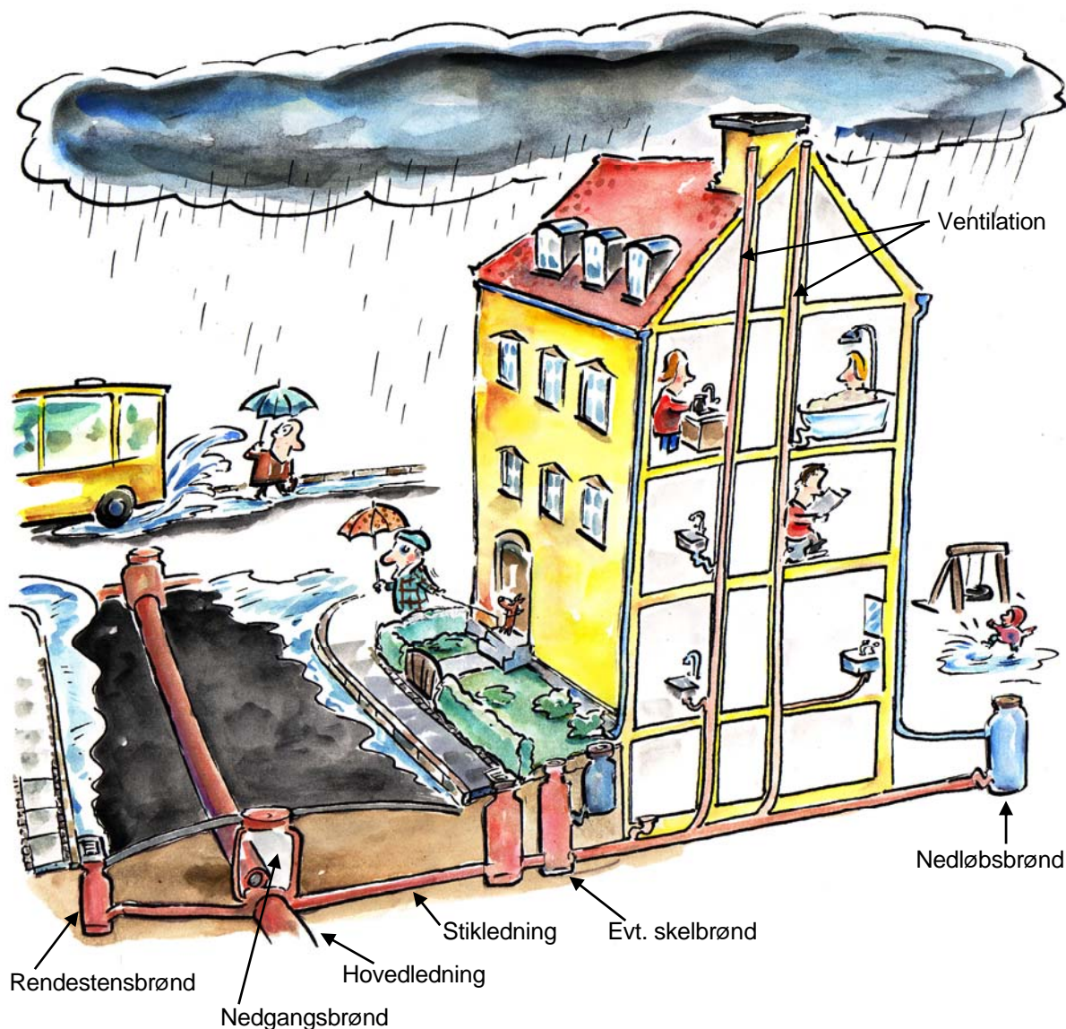
Figur 2. Afløbning af spildevand og regnvand fra en ejendom gennem stikledning til hovedledningen i et fællessystem.
